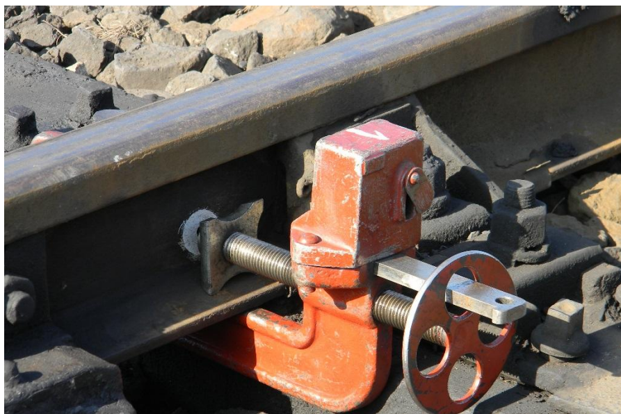
Rys. 1 Miejsce mocowania ostrza śrubowego sworznia spony
