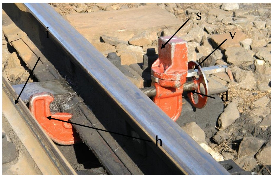
Rys. 2 Zabezpieczenie iglicy odsuniętej
